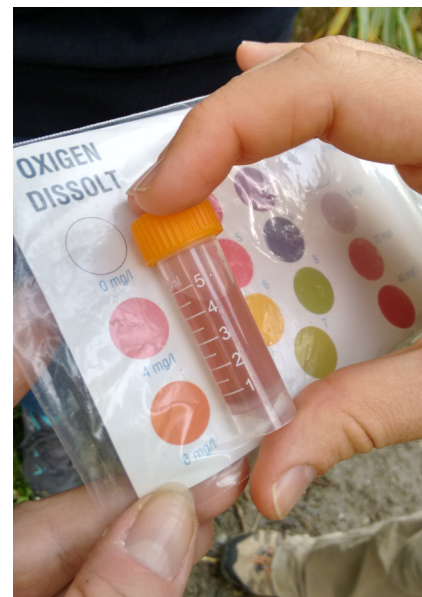
El grup WWF Barcelona determina la concentració d'oxigen dissolt de la riera de Vallvidrera a Molins de Rei.
