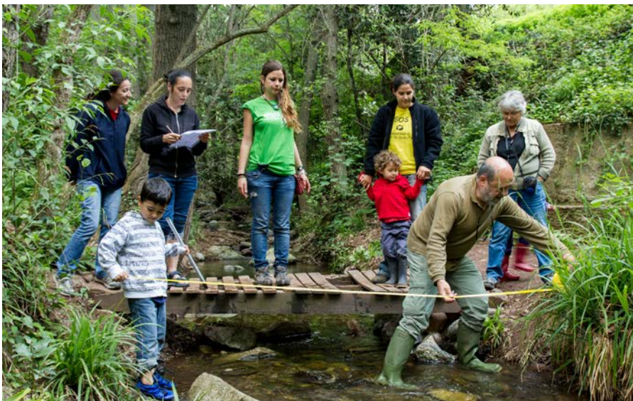
Mesura de l'amplada del tram per tal de determinar el cabal de la riera de Vallcàrquera a Figaró-Montmany durant una formació amb famílies.
